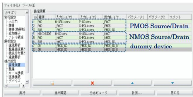
図 7 dummy デバイス設定の論理演算 (例)
