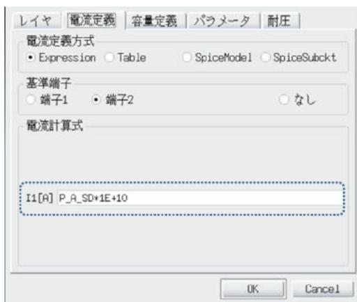
図 9 は DIODE デバイスへ電流値を指定した例です。
