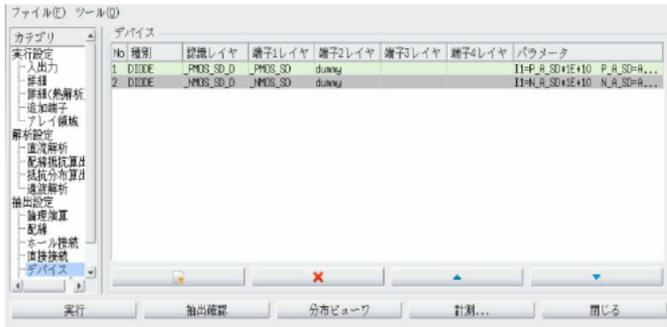
論理演算で定義した dummy デバイスのレイヤを DIODE として定義します。これで MOS デバイスの拡散部分(Source/Drain)をそれぞれ DIODE として認識します。
